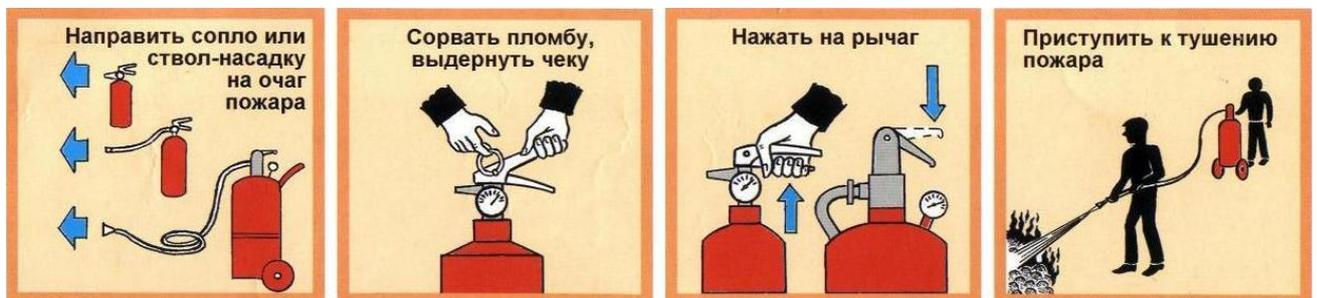
Рис. 3.25. Приведение в действие закачного огнетушителя
