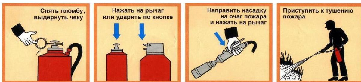
Рис.3.19. Приведение в действие воздушно-пенного огнетушителя
