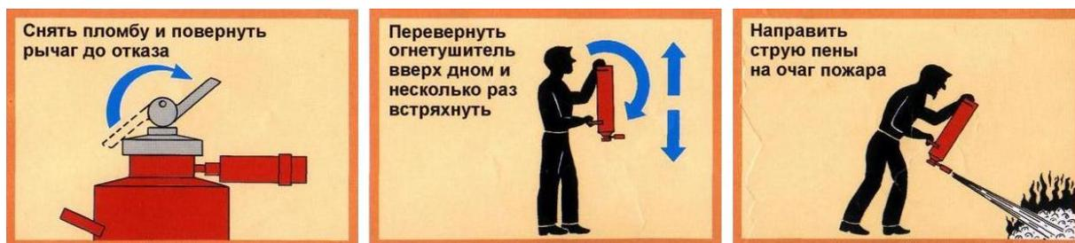
Рис. 3.17. Приведение в действие химического пенного огнетушителя
