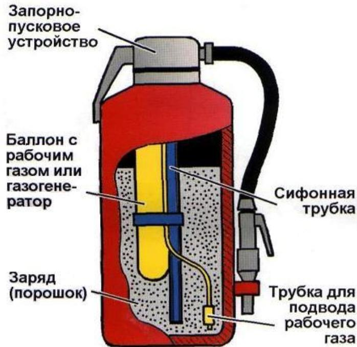
Рис. 3.22. Внутреннее строение порошкового огнетушителя со встроенными газовыми источниками давления
