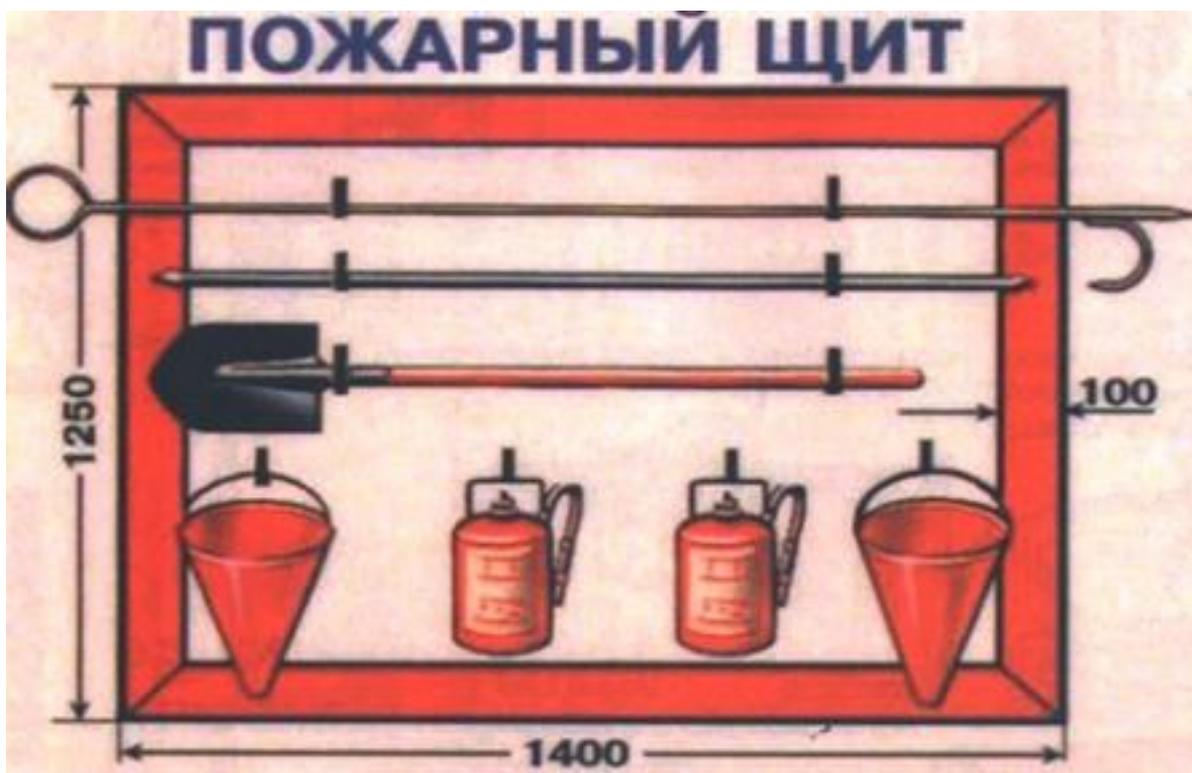
Рис. 3.4. Внешний вид пожарного щита
