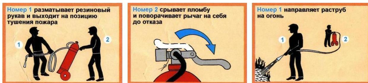
Рис. 3.13. Приведение в действие передвижного углекислотного огнетушителя
