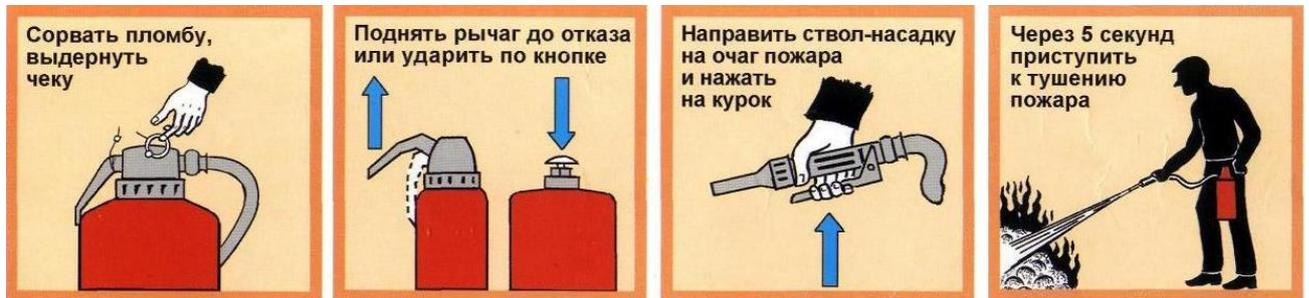
Рис. 3.24. Приведение в действие огнетушителя с газовым источником давления
