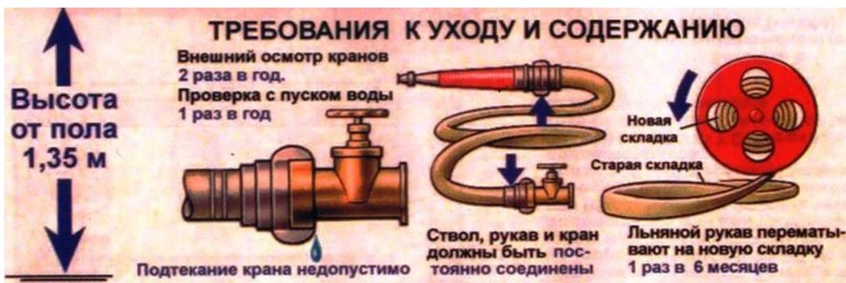
Рис. 3.7. Требования по уходу и содержанию внутреннего пожарного крана
