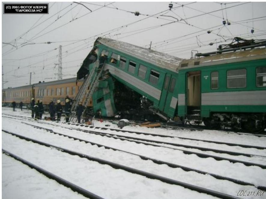
Рис. 5.1. Авария электрички из-за неисправности железнодорожного пути
