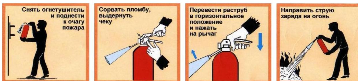
Рис. 3.12. Приведение в действие ручного углекислотного огнетушителя
