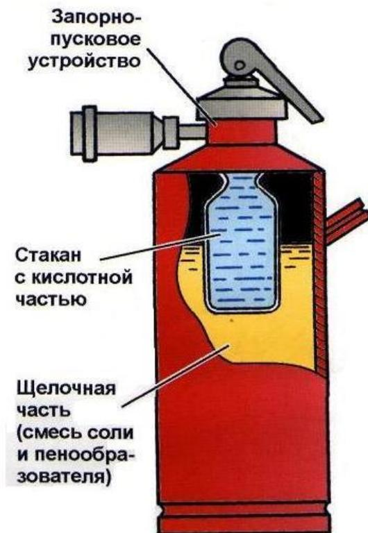
Рис. 3.16. Внутреннее строение химических пенных огнетушителей
